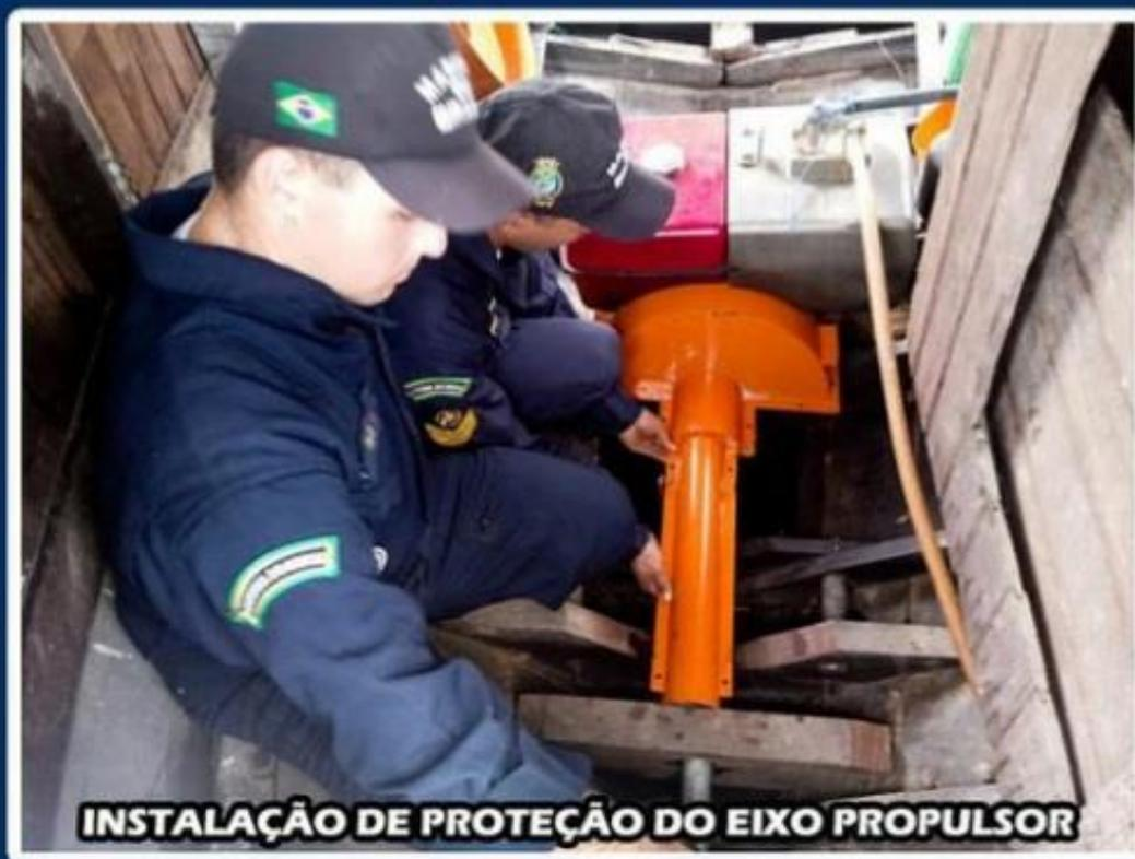
**INSTALAÇÃO DE PROTEÇÃO DO EIXO PROPULSOR**
